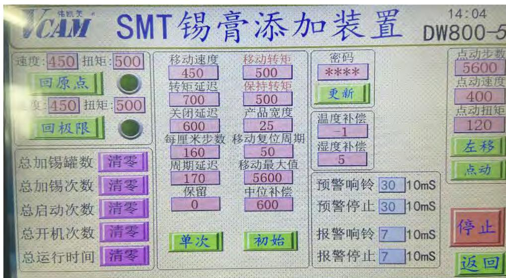
回原点和回极限：设备在复位和启动时左右移动的速度和力度调节建议值 300-500.
