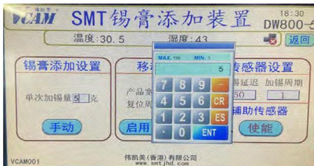
5.2 移动设置：是指加锡过程中移动参数调整，可以根据自身需求调整对应的数值，如加锡移动距离（印刷主板越大，产品宽度数值越大），复位周期是指加锡时 X 轴移动的次数，一次是一个周期，如图显示 50 次移动后会自动复位一次，点击启用可以切换使用或禁用该功能
