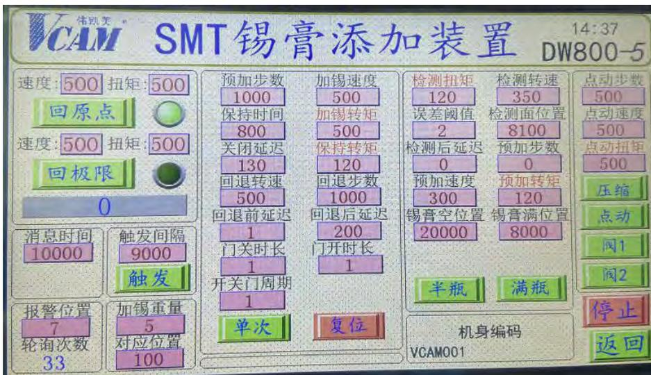
回原点和回极限：设备没有检测到锡膏时，上升和下降速度，建议值 400-500，扭矩是设备上升和下降力的大小，建议值 450；
